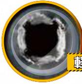
なめたプラスネジの十字穴が軽症の場合はネジザウルスバズーカビット(Initial)を叩かずに押し付けて回すだけで外すことができます。
